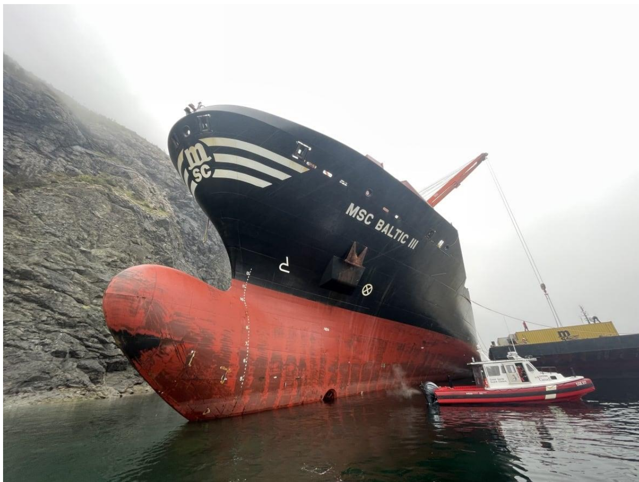
Figure 3 Le porte-conteneurs MSC Baltic III s'est échoué au large de la côte Ouest de Terre-Neuve en février 2025 à la suite d'une panne de moteur. Source de l'image.
