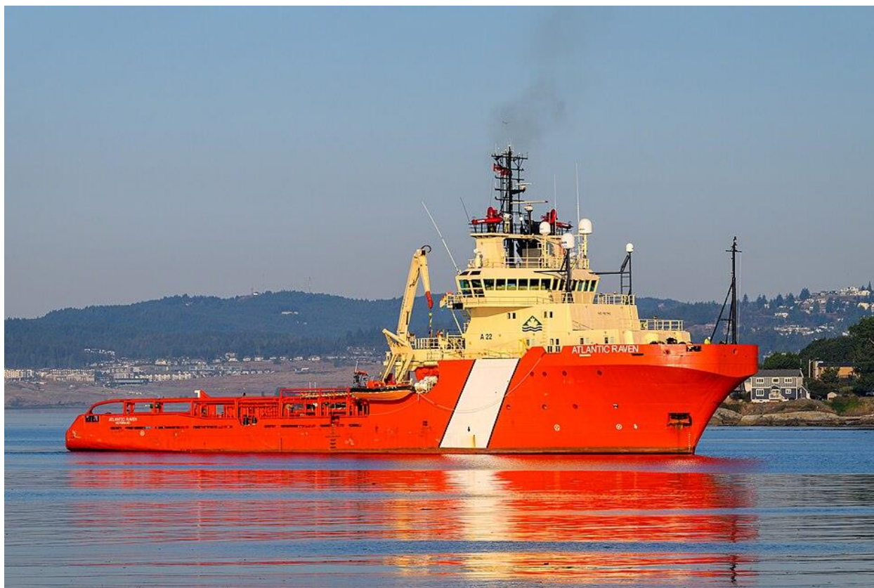
Figure 2 Exemple de navire ravitailleur-remorqueur-manipulateur d’ancres disposant d’une puissance de traction suffisante pour servir de remorqueur d’urgence. [Sur la photo : l’ Atlantic Raven , puissance de traction de 162 tonnes]. Source de l’image.
