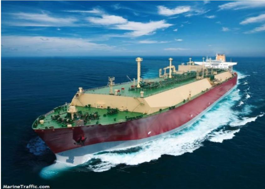
Figure 4. « Méthanier » [Image avec l'autorisation de MarineTraffic.com]
