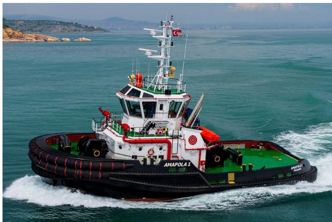
Figure 27. Remorqueur de 30 m, doté d'une puissance de traction de 80 tonnes. [Image avec l'autorisation de Robert Allan.]
